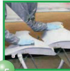
#5 Grundierte Fläche vorbereiten
