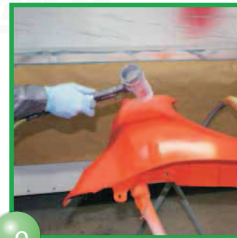
#15&16 Zwei bis drei Schichten Auto Air Colors #4315 halbnass auftragen. Einzelne Schichten vor nächstem Auftrag matt trocknen lassen, Trocknungszeit läßt sich mit Trocknungspistole für Wasserlacke verkürzen.
