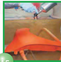
#15&16 Zwei bis drei Schichten Auto Air Colors #4315 halbnass auftragen. Einzelne Schichten vor nächstem Auftrag matt trocknen lassen, Trocknungszeit läßt sich mit Trocknungspistole für Wasserlacke verkürzen.
