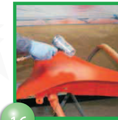
#15&16 Zwei bis drei Schichten Auto Air Colors #4315 halbnass auftragen. Einzelne Schichten vor nächstem Auftrag matt trocknen lassen, Trocknungszeit läßt sich mit Trocknungspistole für Wasserlacke verkürzen.
